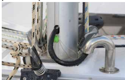
Nahoře a vlevo: Výtahy jsou od stěžně vedeny na vinšny pod střešou nástavby. Dole: Vedení kabelů do stěžně, který je postaven na palubě.
