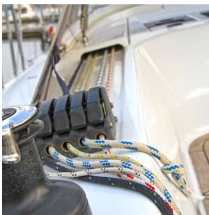
Nahoře a vlevo: Výtahy jsou od stěžně vedeny na vinšny pod střešou nástavby. Dole: Vedení kabelů do stěžně, který je postaven na palubě.
